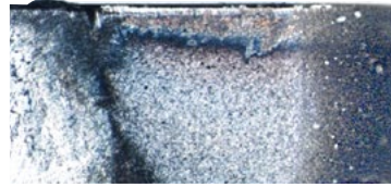
Techniks CNMG insert - After 22 min.
