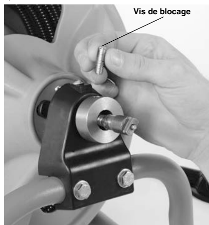
Figure 3 – Retirer et jeter la vis de blocage du câble
