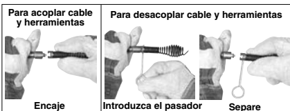
Figura 12 – Acoplamiento y desacoplamiento de herramientas al cable
